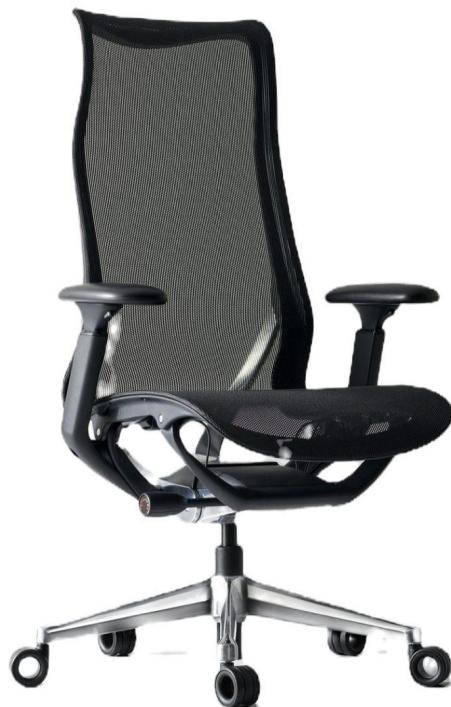
Sedia direzionale con schienale alto - Ruote in PU Diam 60 mm - Base in Alluminio Ray 340 - Gaslift SGS Tested Class 4 - Corsa 100 mm - Meccanismo Synchro Autogravity system con tensione regolabile bloccabile in 4 posizioni - Sistema di controllo a filo (Wire control system) - Sedile e schienale completamente in Mesh - Braccioli regolabili 4D con pad in PU morbido.
