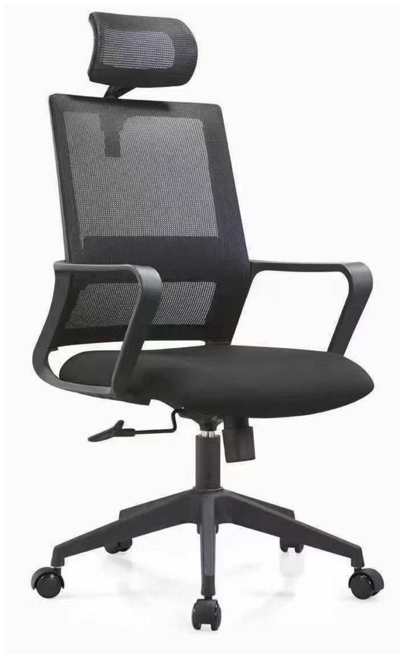
Sedia operativa con schienale medio - Ruote in PU diam. 50 mm - Base in nylon Ray 310 - Alzata a gas Bifma Tested Classe 3 - Corsa 120 mm - Meccanismo di inclinazione con tensione regolabile bloccabile in 2 posizioni - Spessore del metallo 2,5 mm - Schiuma tagliata di alta qualità per il sedile - Schienale in rete - Bracciolo in nylon nero integrato nella struttura - Supporto lombare fisso - Poggiatesta fisso
